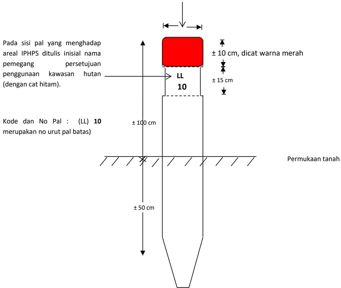
Tanda batas pipa paralon yang diberi bahan cor beton rangka besi
